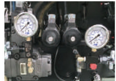
油壓系統採用日本油研(YUKEN)之比例控制閥 Hydraulic System from YUKEN, Japan
